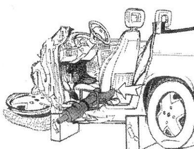
Cuando no existiera un mecanismo de reciclaje, o cuando la parte estuviera abollada, o el asiento solo incorporara un sistema de ajuste de reclinación, será probablemente reclinar forzándolo o incluso extraer el respaldo de la butaca.
