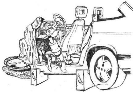
Cuando se esté tratando de cortar el panel de la cunera puede esperarse que el cortante haga un movimiento hacia abajo, particularmente cuando las pinzas de éste atrapan la plancha de seguridad que se halla en la cara posterior de la estructura. Los operadores de estas herramientas deben evitar, por el motivo antes explicado, estar en una posición que ubique sus rodillas debajo del artefacto.
