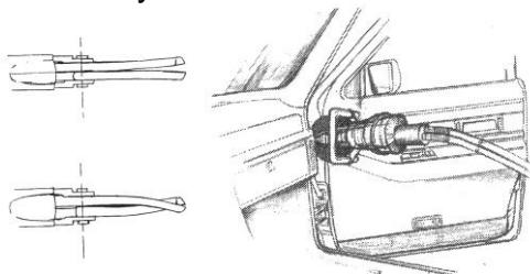
Arrancar estructuras fuertes, como por ejemplo las bisagras de la puerta, se deben hacer con sumo cuidado y precisión para evitar la separación de las hojas (pueden cruzarse o abrirse) al trabajar sobre bisagras, pestillos metálicos y estructuras de metal muy resistentes.
